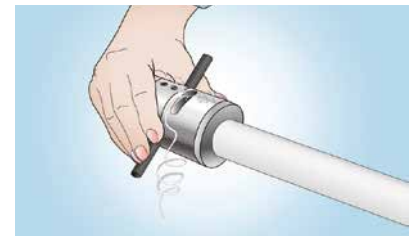
2. При помощи специального инструмента зачистки снимите верхний слой из ППР и слой алюминия. Перед сваркой убедитесь, что алюминий полностью зачищен
