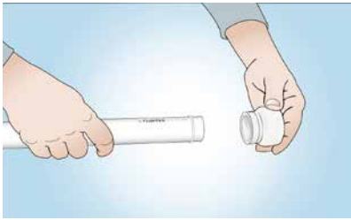
7. Быстро вставьте нагретую трубу в фитинг
