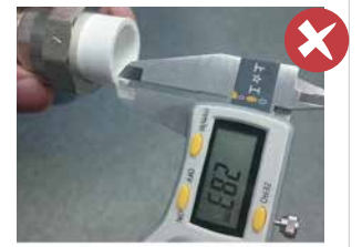
Российский производитель К... Толщина пластиковой втулки на американке российского производителя К... близка к PN10...
