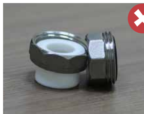
Российский производитель П... Количество витков: 2.5 На данном образце полностью закрутить гайку не получилось по причине недостаточной глубины внутренней резьбы гайки
