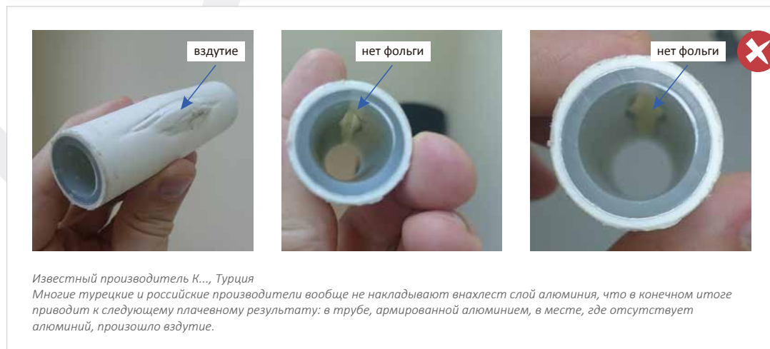
Расслоения и пузыри в данных случаях произошли по причине использования некачественного адгезива, а также, вероятно, из-за нарушения технологии производства
