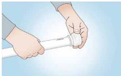
8. Время соединения и время охлаждения должны точно соблюдаться. Небольшое корректирование положения допустимо в момент соединения
